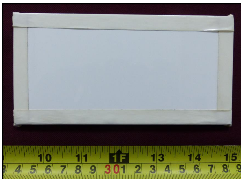
Fotografía 4 Aspecto general de la muestra 16CR0051 después de 1000 horas de ensayo en cámara de humedad.
