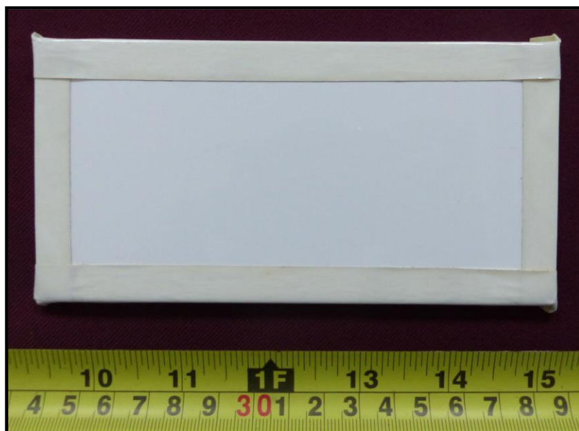
Fotografía 6 Aspecto general de la muestra 16CR0052 después de 1000 horas de ensayo en cámara de humedad.
