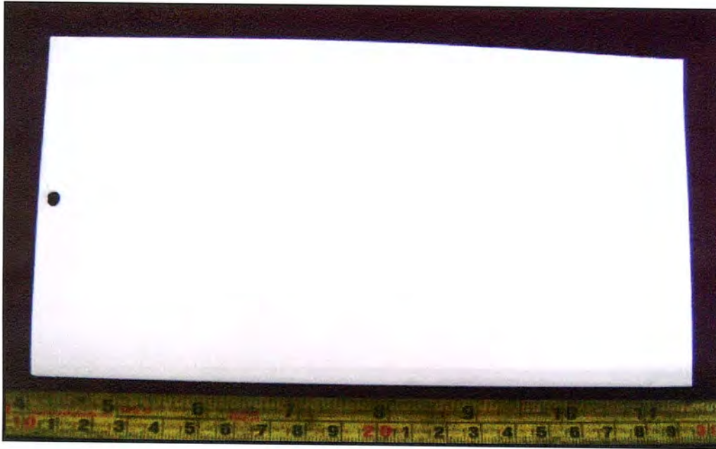
Fotografía 1 Aspecto general de la muestra 10CR0063 antes del ensayo en cámara salina.
